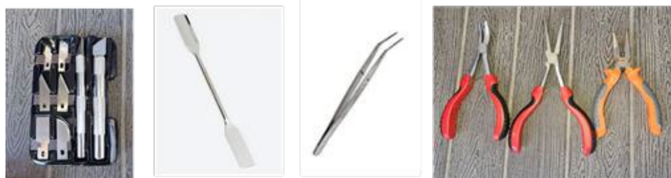
Figure 38 - esempio di utensili per il prelievo di campioni friabili
